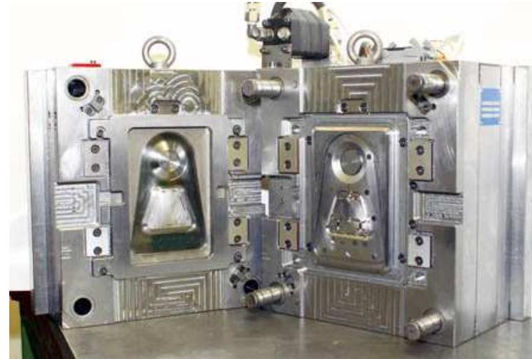
Eine Werkzeuggebundene Produktion ist deutlich effizienter, jedoch ist für jede Variante ein weiteres, meist sehr aufwendiges, Werkzeug notwendig. Metallguss, Kunststoffspritzguss, Betonguss, Tortenguss ;-))
