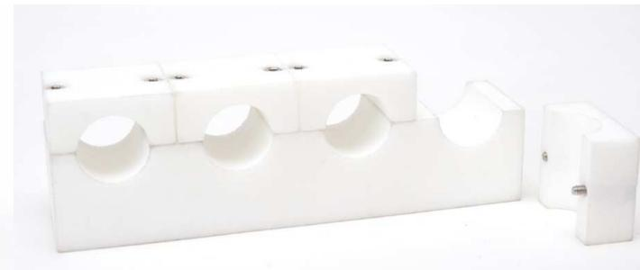
Konventionell konstruierte Lasersintererteile
